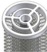
**PARTIE ACTIVE: Cartouche de filtrage INNOVATIVE** composé de 3 couches en acier inoxydable avec différents degrés de filtrage. L'acier inoxydable est durable et très fiable avec différentes conditions de fonctionnement de pression et de température. De plus, l'INOX n'est pas sensible à la corrosion et à l'usure due à la pollution.
