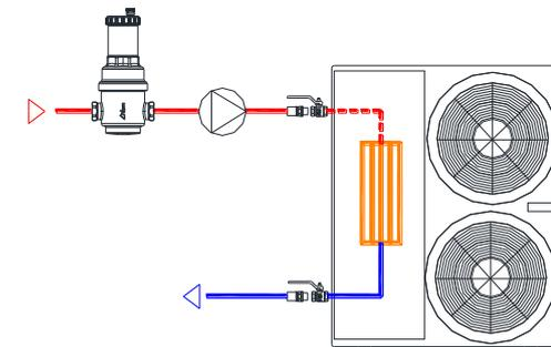
*Schéma 2: Airterm installé sur le retour de l'installation, en amont d'un refroidisseur.*
